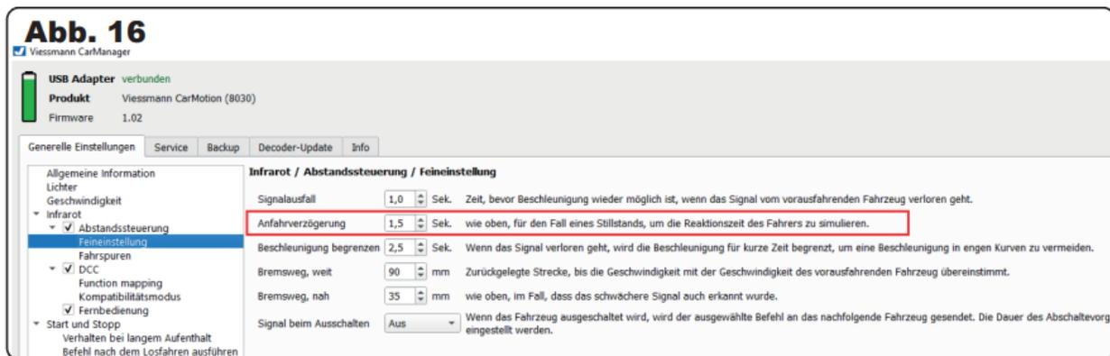
De optie "Begrenzing versnelling" geeft de tijdspecificatie van de verminderde versnelling aan waarmee een volgend voertuig versnelt tot de ingestelde basissnelheid in geval van signaalverlies (afb.17). Deze optie kan bijvoorbeeld nuttig zijn in scherpe bochten, waar het "visuele contact" met de voorligger even verloren gaat.
