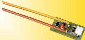
**Platine mit zwei LEDs für Hausbeleuchtung:**
