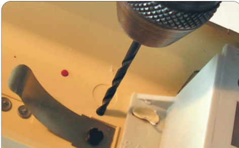
Lokgehäuse abnehmen und Loch bohren (1,5 mm). Remove the case of the loco and drill a hole (1,5 mm).
